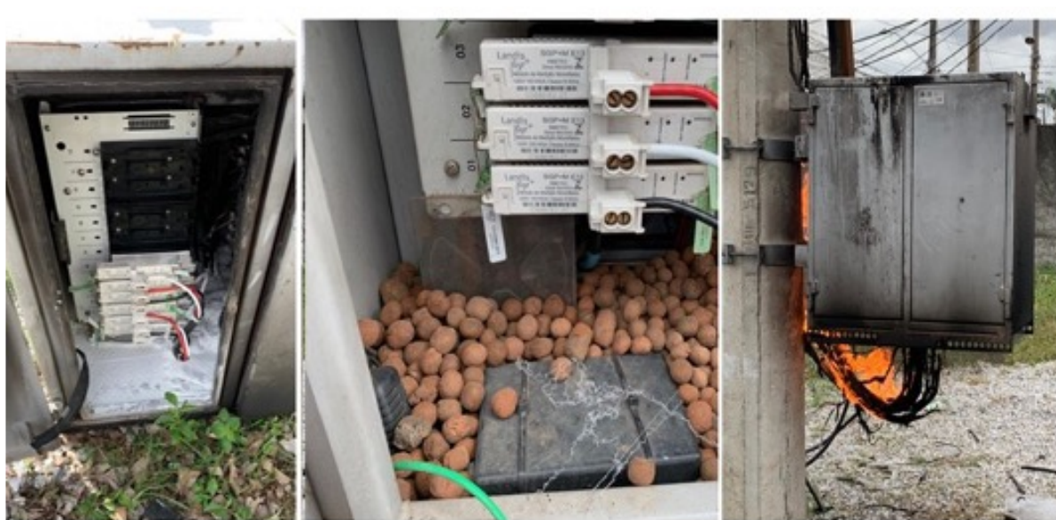
Figura 04. Registros do teste de campo. À esquerda, a caixa de energia blindada antes e depois do posicionamento das LECAs-modificas. À direita, fogo controlado na caixa teste.
