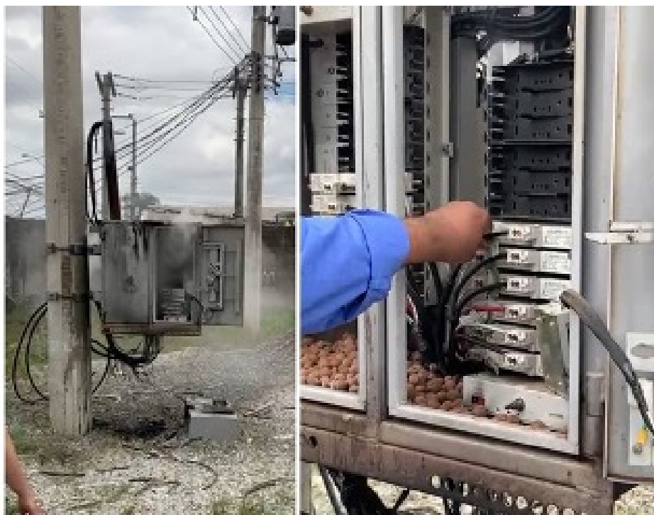
Figura 05. Registros do teste de campo. À esquerda, a caixa após o incêndio controlado aberta. À direita, a conferência manual pelo técnico da integridade dos componentes e temperatura interna.
